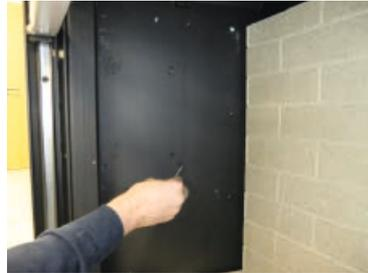
4. Schrauben M5x7 mm mit 3 mm Inbusschlüssel rechts und links lösen und die Revisionsdeckel beidseitig entnehmen.
