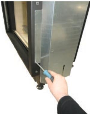
**2.** Schrauben der Gewichtschachtabdeckung mit Kreuzschraubendreher lösen...
