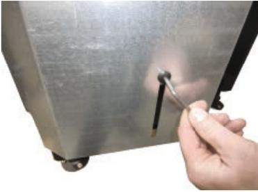
**1.** Die Schrauben der Transportsicherung mit Inbusschlüssel 4 mm rechts und links demontieren.
