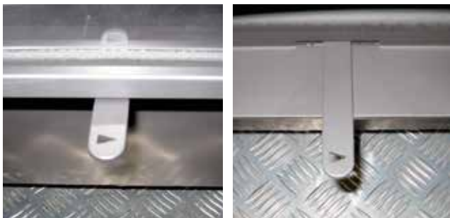
Abb.:3 Mit Hilfe des Verbrennungsluftschiebers kann der Abbrand beeinflusst werden. Bei Ekko Kamineinsätzen ist die Schieberichtung umgekehrt, als auf dem Bild dargestellt.
