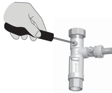
**Hinweis:** Bei den Hochleistungs-Hydraulikgruppen verändert die Pumpe die Flussmenge anhand der Temperaturdifferenz, die zwischen den Solarkollektoren und dem Speicher besteht, womit keine manueller Regler benötigt wird. Der manuelle Flussmengenregler wird benutzt, um die Pumpe vom Kreislauf zu trennen.
