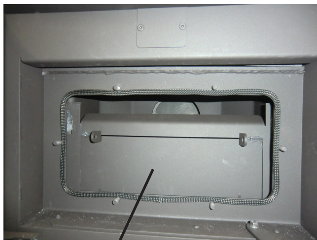
Fig. 5 Pared de separación del intercambiador de calor de agua
