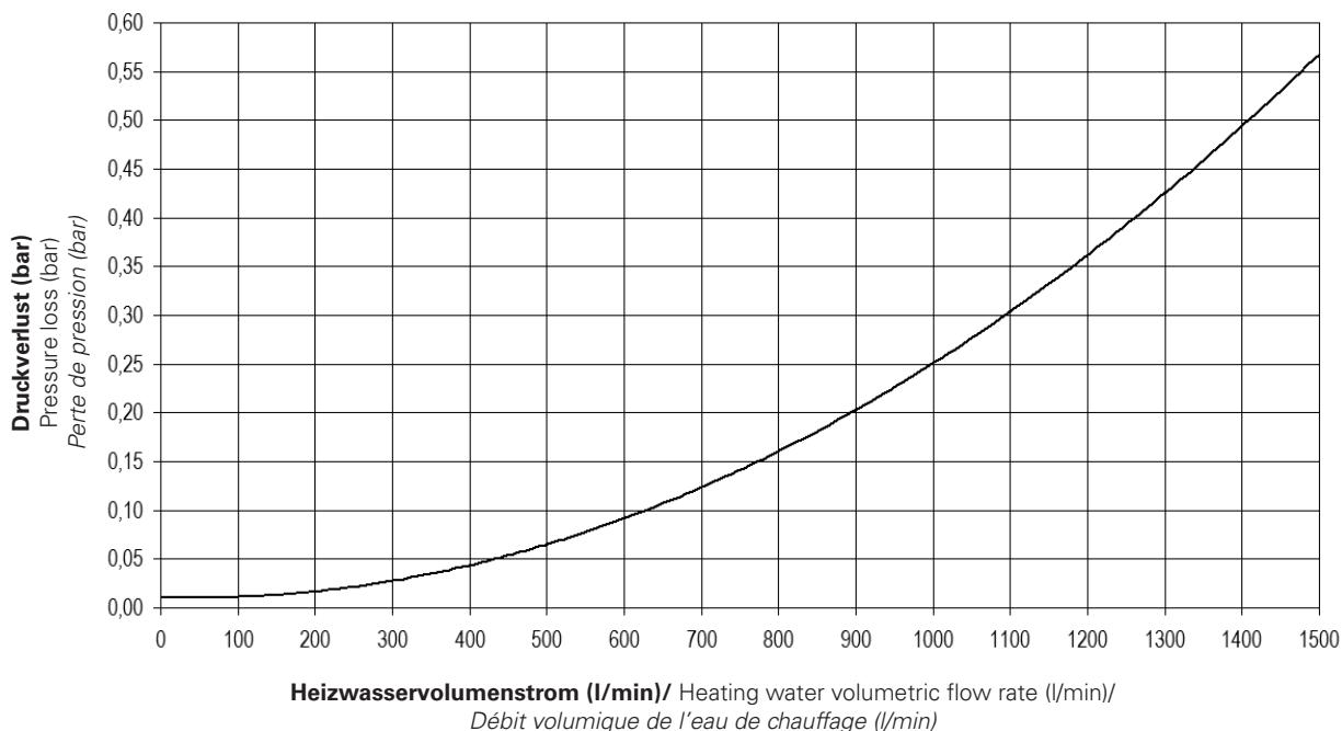
**Kennlinie/ Characteristic curve/ Crarctéristique Grundfos UPS 15-60**
