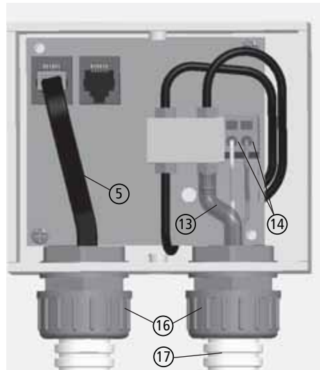
Abb. 4.5 Kabelführung und Leerrohre des Unterputzgehäuses
