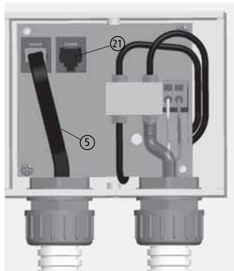
Abb. 4.10 Bedien- und Messeinheit, Anschluss der Datenbusleitung
