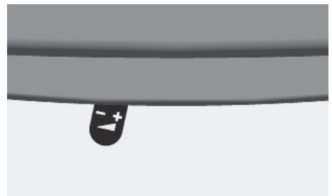
Abb. 4.10 Verbrennungslufschieber ganz nach links geschoben - Verbrennungsluft komplett geschlossen
