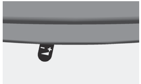
Abb. 4.7 Verbrennungslufschieber ganz nach links geschoben - Verbrennungsluft komplett geschlossen
