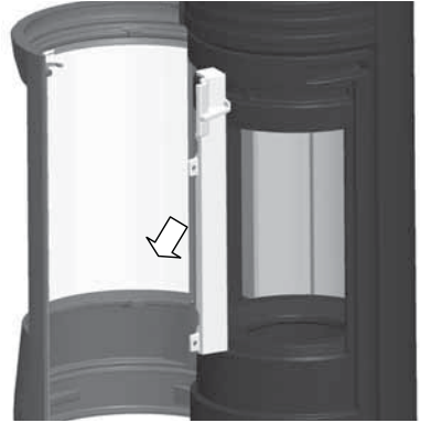
Abb. 8.4 Nur einen seitlichen Luftkanal demontieren
