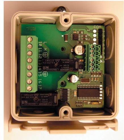
Die Relaisbox wird mit Konsole zur direkten Montage am Motor geliefert. Beide Klemmen für den Anschluss sind abnehmbar. Klemme 1-6 ist bei Lieferung lose, um die Montage zu vereinfachen.
