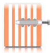
Abb. 6 Beispiel, Injektionsankerbefestigung bei Mauerwerk
