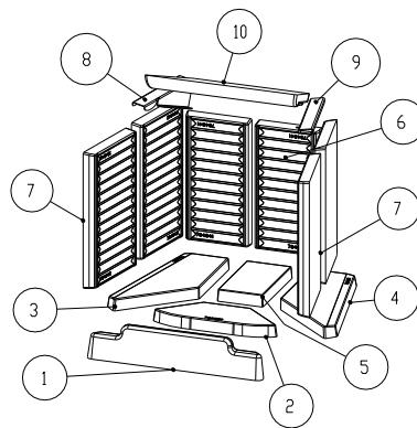
Numerazione dei refrattari = ordine da seguire per il montaggio!
