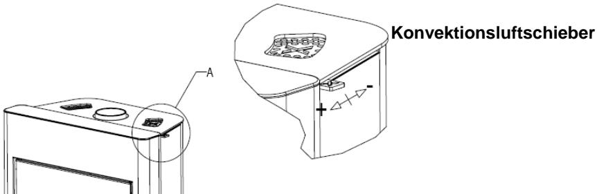
Unser Tipp: Während das Feuer brennt die Konvektionsluft offen lassen und danach schließen, um eine lange, gleichmäßige Wärmeabgabe zu erreichen.
