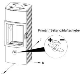
Fig. 4: Regolazione della levetta dell'aria
