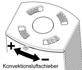
Konvektionsluftschieber = convection air lever
