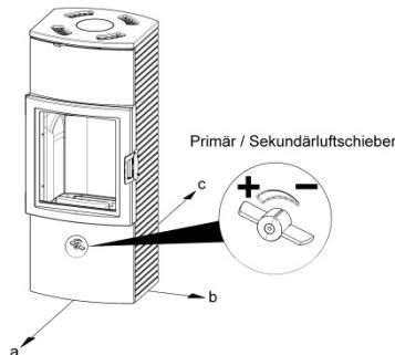
Fig. 4: régler l'arrivée d'air
