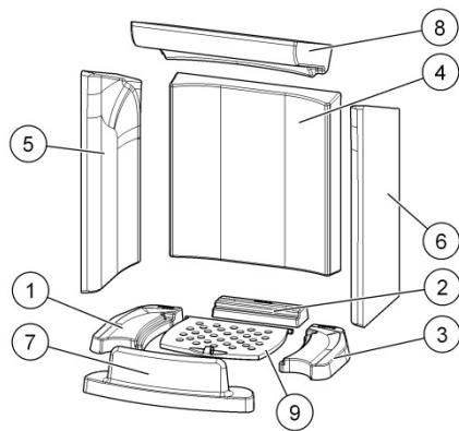
Numerazione dei refrattari = ordine da seguire per il montaggio!
