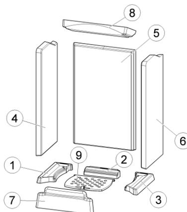
Numerazione dei refrattari = ordine da seguire per il montaggio!
