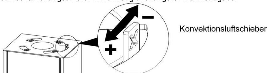
Unser Tipp: Während das Feuer brennt die Konvektionsluft offen lassen und danach schließen, um eine lange, gleichmäßige Wärmeabgabe zu erreichen.
