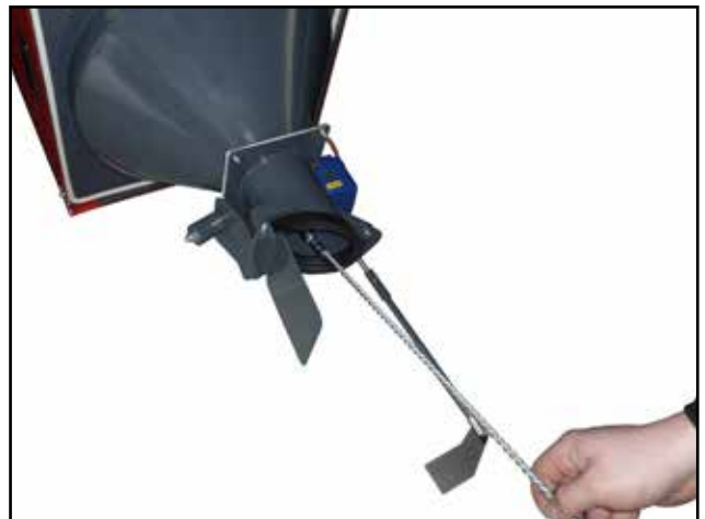
Bürsten des Siebs durch die Brennstoff-Ausschüttöffnung
