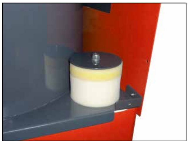
Schaumstofffilter auf den Austritt aus dem Pelletsvorratsbehälter
