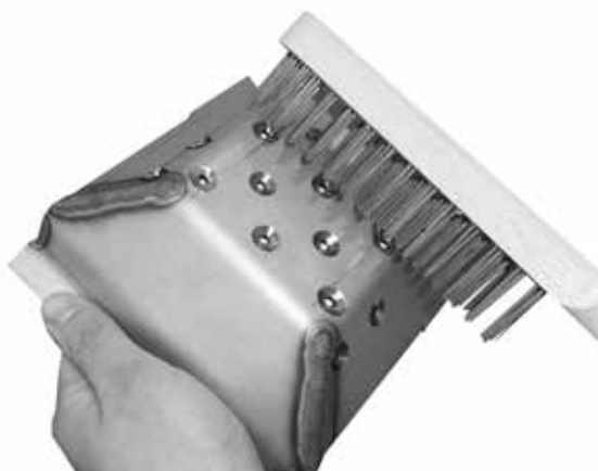
Beispiel: Reinigung der Brennkammer
