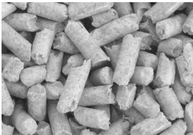
Hochwertige Holzpellets – Weißpellets ohne Schwarzpunkte (Rinde)
