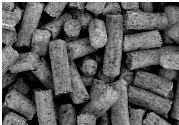
Holzpellets schlechter Qualität – Dunkelpellets mit Rinde (mit schwarzen Punkten)
