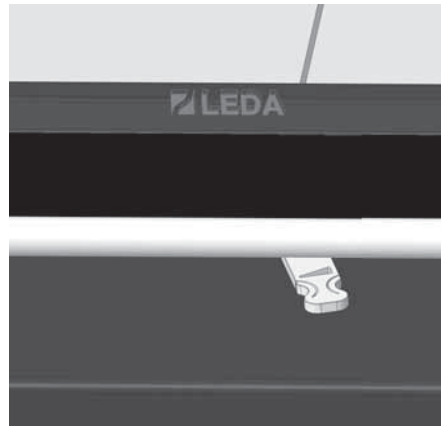
Abb. 4.6 Luftschieber ganz rechts, über den Anschlag hinaus, in Anheizstellung (TIGA D) oder bei Speicherbetrieb (TIGA N)
