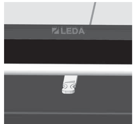
Abb. 4.15 Luftschieber rechts, bis Anschlag – 100 % Verbrennungsluft komplett geöffnet (TIGA D)
