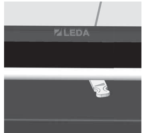
Abb. 4.11 Luftschieber ganz rechts, über den Anschlag hinaus, in Anheizstellung (TIGA D) oder bei Speicherbetrieb (TIGA N)
