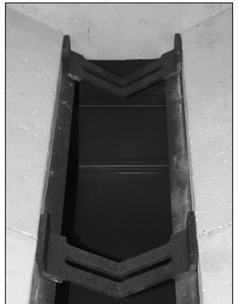
Die Ablagerung von Abstandhalter im Kessel D 45 P . Bei Einsatz des Brenners A 70 Petro.
